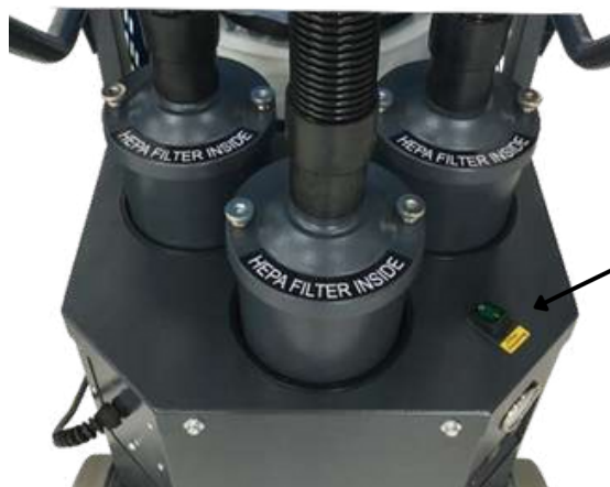
Przełącznik czyszczenia filtra
